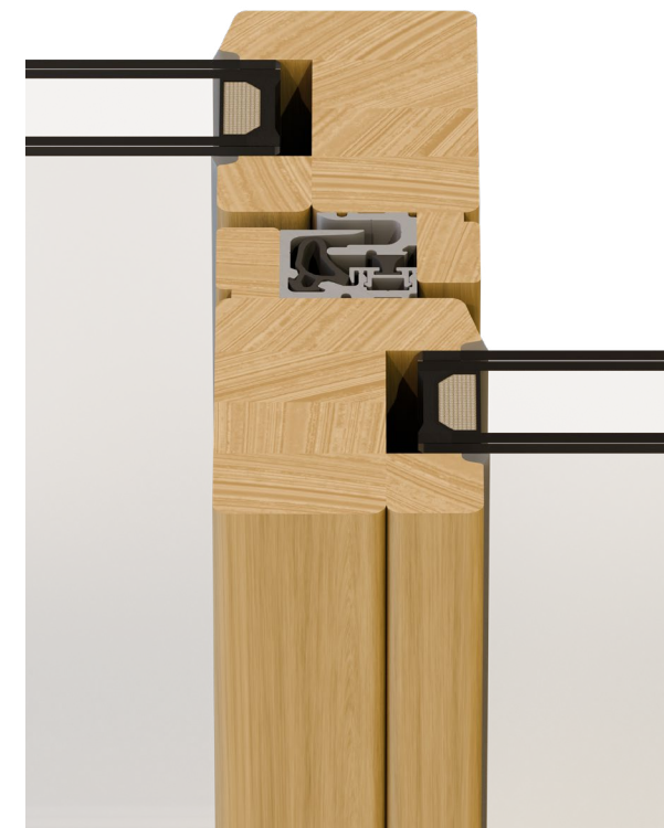
NODO CENTRALE RIDOTTO 50MM CON CHIUSURA TECNICA A LABIRINTO UNI-V
