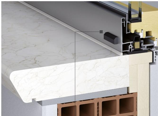
Drenaje de agua mediante desagües.
