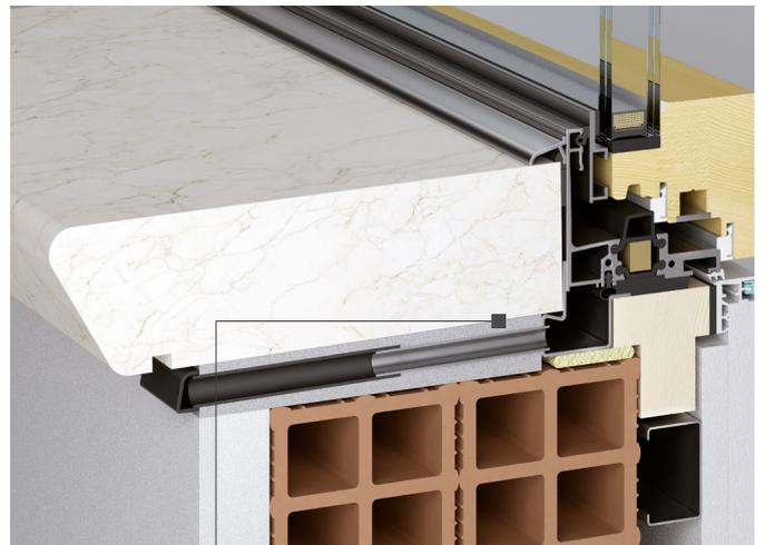
Drenaje de agua mediante desagües instalados en el premarco.
