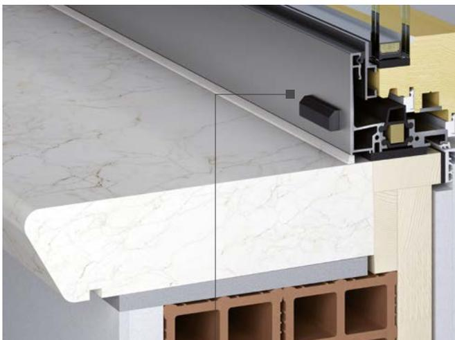
Drenaggio delle acque attraverso appositi deflussi (con telaio in appoggio).
